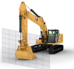
前方电子墙壁
